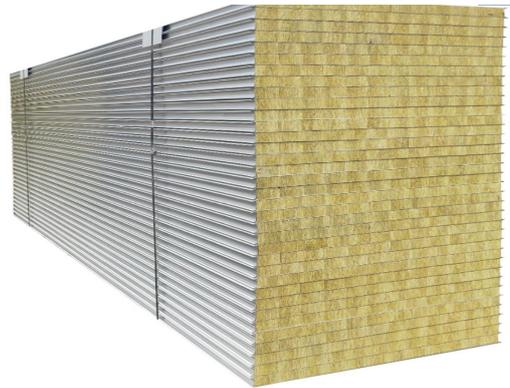
吊顶采用玻镁岩棉夹芯彩钢板，厚度 50mm，抗折强度 $\geq 14\text{MPa}$ ，防火等级为 A1 级。样式如下图：
